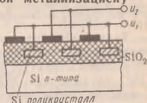
Рис. 6.17. Структура секции переноса ПЗС с рядом скрытых затворов из поликристаллического кремния
