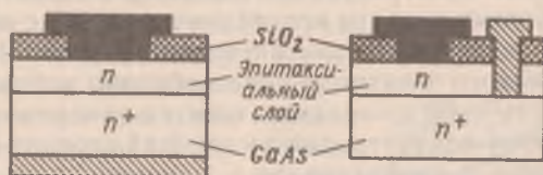
Рис. 3.47. Варианты структур диодов Шотки с двух- слойной базой
