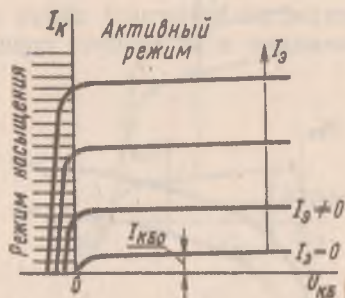
Рис. 4.14. Выходные статические характеристики транзистора, включенного по схеме с общей базой
