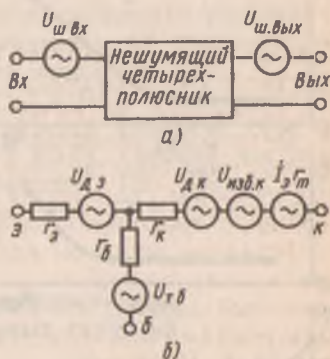
Рис. 4.47. Шумовые эквивалентные схемы транзисторов: а — формальная, б — физическая
