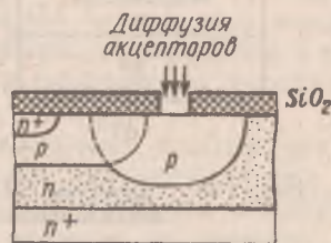
Рис. 4.51. Периферийная часть структуры эпитаксиально-планарного транзистора с диффузионным охранным кольцом, сформированном дополнительной диффузией акцепторов
