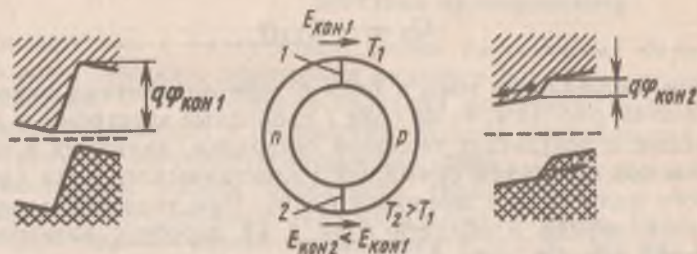
Рис. 13.3. Появление термо-ЭДС из-за температурной зависимости контактной разности потенциалов при коротком замыкании ветвей термоэлемента и энергетические диаграммы спаев, находящихся при разных температурах
