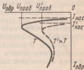
Рис. 3.22. ВАХ диода с учетом выделения теплоты в p - n -переходе при разных температурах окружающей среды
