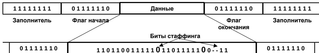
Выделение границ кадра с помощью бит - стаффинга
