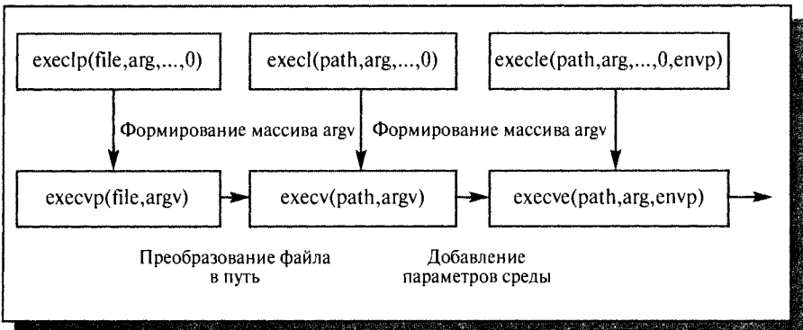
Рис. 3-4.3. Взаимосвязь различных функций для выполнения системного вызова exec()
