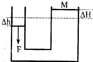
Большой поршень гидравлической машины поднимает груз массой  $M = 400$  кг (см. рисунок). При этом на малый поршень действует сила  $F = 160$  Н. На какое расстояние  $\Delta h$  опустится малый поршень, если большой поднимется на  $\Delta H = 5$  см?
