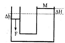
Большой поршень гидравлической машины поднимает груз массой М = 400 кг (см. рисунок). При этом на малый поршень действует сила F = 160 H. На какое расстояние  $\Delta h$  опустится малый поршень, если большой поднимется на  $\Delta H = 5$ см?
