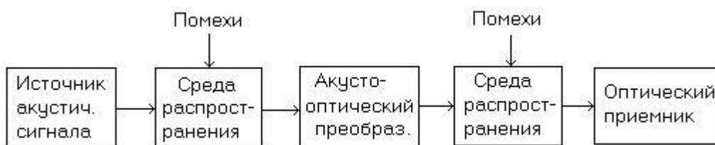
Рисунок 1 - Структурная схема канала утечки информации
