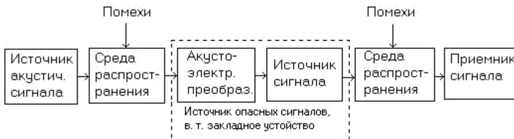
Рисунок 2 - Структурная схема канала утечки информации
