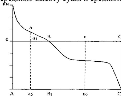
Для определения средней высоты суши отрезок АВ<sub>1</sub>, соответствующий площади, занимаемой сушей разделить пополам и от этой точки восстановить перпендикуляр до пересечения с гипсографической кривой (а<sub>1</sub>, а<sub>2</sub>). Ордината точки пересечения кривой и будет средняя высота суши. Точно также следует определить среднюю глубину Мирового океана (перпендикуляр здесь следует опустить от уровня моря до гипсографической кривой).
