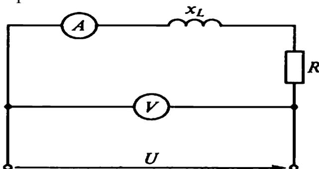
**Задание №4.** Идеальная катушка с индуктивностью  $26 \text{ мГн}$  включена в сеть с напряжением  $220 \text{ В}$  и частотой  $50 \text{ Гц}$ . Определите ток, проходящий через катушку (в амперах), мощность цепи и максимальную энергию магнитного поля катушки.
