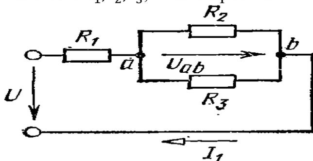
**Задание №4.** Построить потенциальную диаграмму для цепи изображенной на рисунке, если цепь имеет параметры:  $E_1=18$  В;  $E_2=46$  В;  $R_1=4$  Ом,  $R_2=2$  Ом,  $R_3=6$  Ом,  $R_{01}=R_{02}=1$  Ом.
