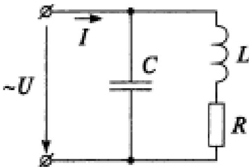
**Задание №4.** Двигатель переменного тока, потребляющий 10 кВт при номинальном напряжении 220 В и частоте 50 Гц, имеет коэффициент мощности 0,82. Определить емкость батареи конденсаторов, которую нужно подключить параллельно двигателю, чтобы коэффициент мощности установки до 0,93.
