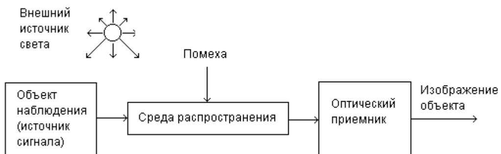
Рисунок 6 - Структурная схема канала утечки.
