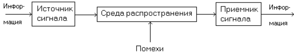
Рисунок 5 - Структурная схема канала утечки.
