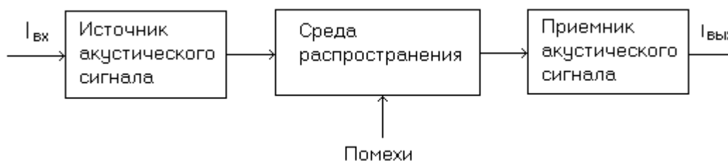
Рисунок 3 - Структурная схема канала утечки информации.
