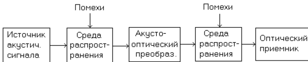
Рисунок 1 - Структурная схема канала утечки информации.
